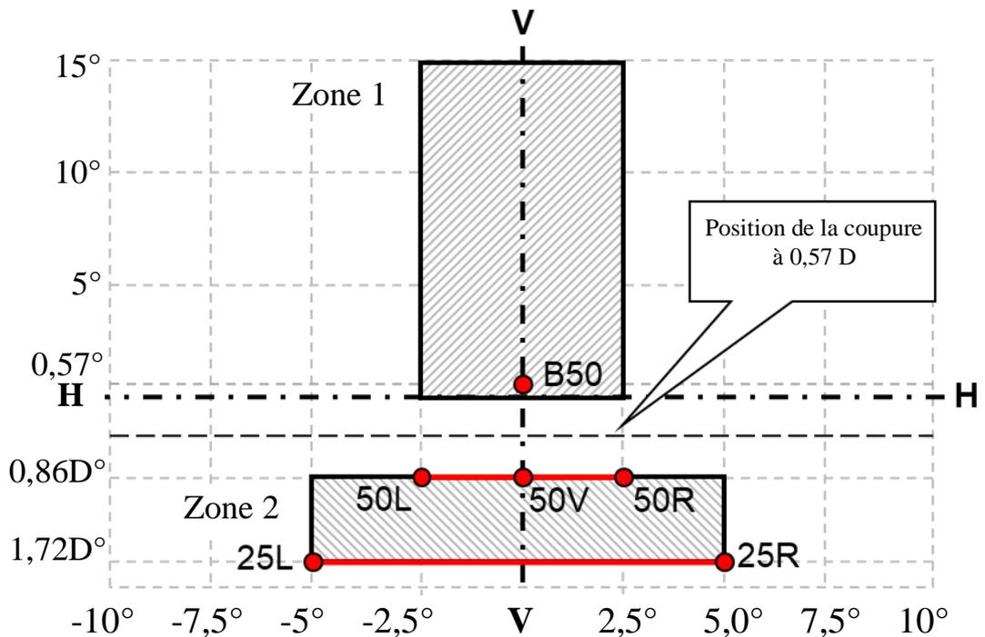
H-H et V-V : plan horizontal et plan vertical s'intersectant sur l'axe optique du projecteur.
