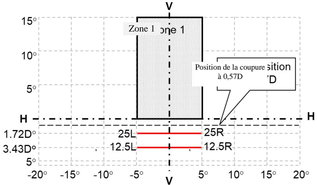
H-H et V-V : plan horizontal et plan vertical s'intersectant sur l'axe optique du projecteur.
