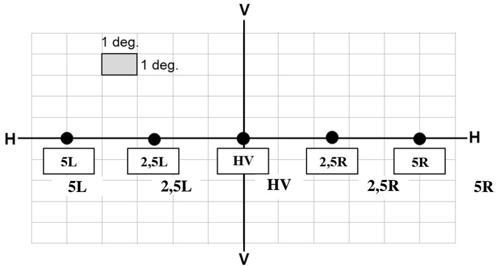
H-H et V-V : plan horizontal et plan vertical s'intersectant sur l'axe optique du projecteur.
