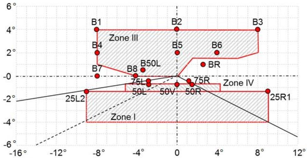
Pour la circulation à gauche, l'emplacement des points d'essai est refléchi symétriquement par rapport à l'axe V-V.
