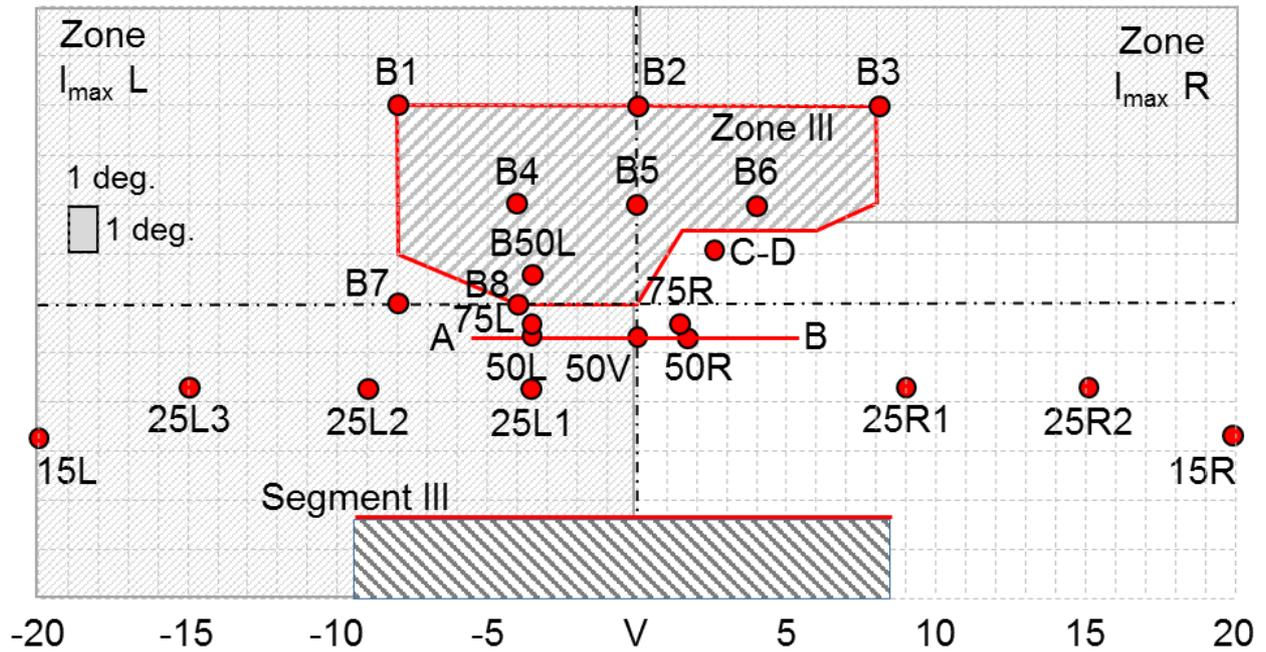
H-H et V-V : plan horizontal et plan vertical s'intersectant sur l'axe optique du projecteur.
